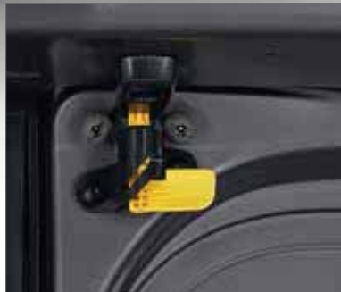
Arka kapı kilit mekanizması
